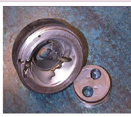
شکل ۵ | اثر ساییدگی ماسه بر روی کاهنده ثابت سرچاهی
