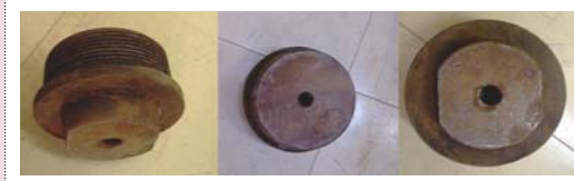
شکل ۳ | کاهنده جریانی ثابت سر چاهی با قطر ۱/۲ اینچ
