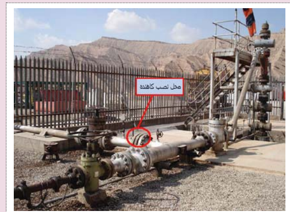
شکل ۲ | نمایی از تاج چاه و محل قرار گرفتن کاهنده ثابت سرچاهی
