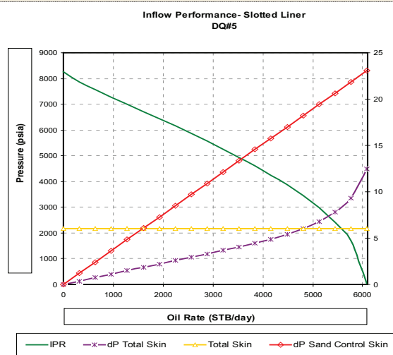
شکل ۸ | منحنی های IPR و افت فشارهای مختلف در حالت استفاده از آستری شکافدار
