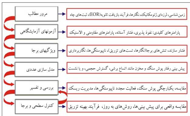
۵ | فرآیند ساخت یک مدل ژئومکانیکی [۲۸]
