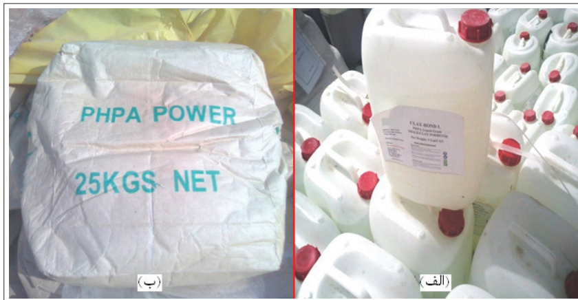
۴ | الف) PHPA در حالت مایع در بشکه های ۵ گالنی ب) PHPA در حالت جامد در کیسه های ۲۵ کیلوگرمی
