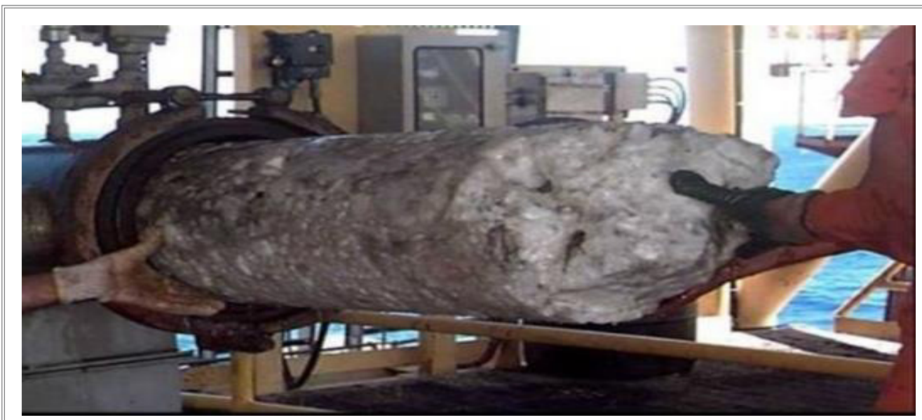
شکل ۱ | انسداد لوله‌های انتقال گاز توسط هیدرات
