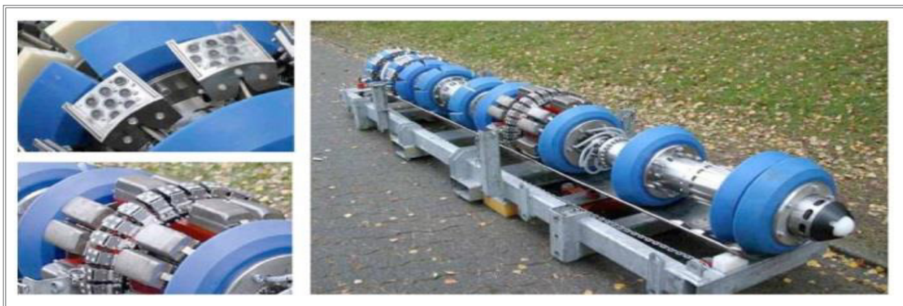
شکل ۴ ترکیب UT و MFL در NDT بر روی ربات IPIR
