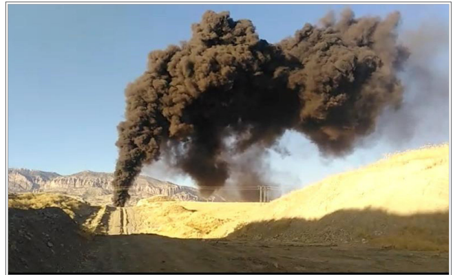
شکل ۴ | خروج دوده از ایستگاه هنگام عملیات توپک‌رانی با ارتفاع بیش از ۱۵۰ متر
