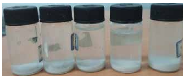
شکل ۶ | میزان پایداری نانوذرات سیلیس با قطر ۱۰۰-۸۰ نانومتر برای ۴ غلظت مختلف در طی یک هفته
