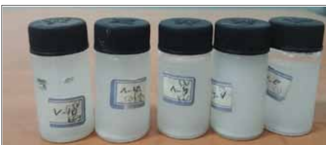
شکل ۵ | میزان پایداری نانوذرات سیلیس با قطر ۱۰۰-۸۰ نانومتر برای ۴ غلظت مختلف در طی ۴۸ ساعت
