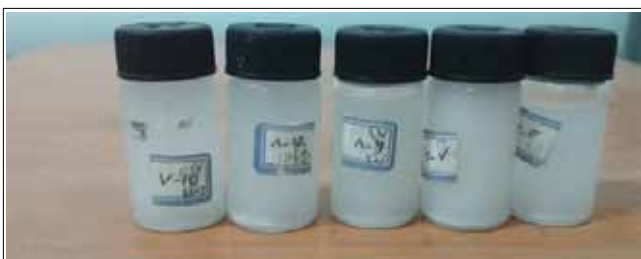
شکل ۳ | میزان پایداری نانوذرات سیلیس با قطر ۱۵-۱۰ نانومتر برای ۴ غلظت مختلف در طی ۴۸ ساعت
