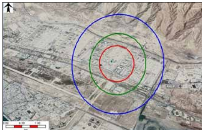
شکل ۲۲ | شعاع تحت تأثیر شدت امواج در آتش استخری سریع در فصل گرم در اثر تخلیه‌ی کل موجودی مخزن
