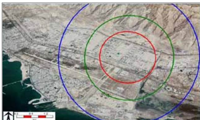
شکل ۵ | شعاع تحت تأثیر شدت امواج در آتش استخری تأخیر یافته در فصل گرم در اثر گسست مخزن
