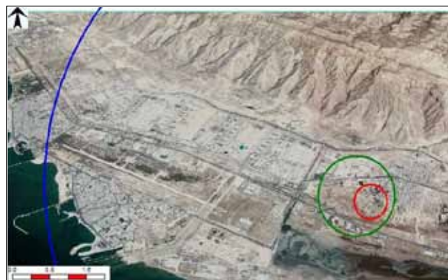
شکل ۸ | شعاع تحت تأثیر انفجار تأخیر یافته همراه با شدیدترین امواج در فصل سرد در اثر گسست مخزن
