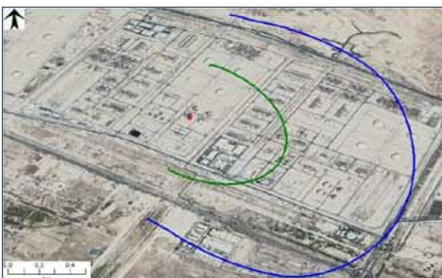
شکل ۲۹ | شعاع تحت تأثیر حداکثر غلظت گاز انتشار یافته در فصل سرد در اثر تخلیه‌ی کل موجودی مخزن
