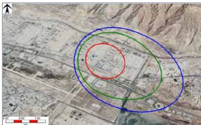
شکل ۱۰ | شعاع تحت تأثیر حداکثر غلظت گاز انتشار یافته در فصل سرد در اثر گسست مخزن
