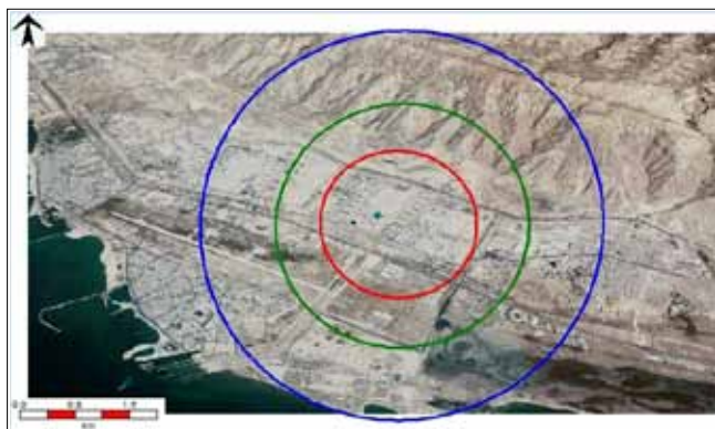
شکل ۶ | شعاع تحت تأثیر شدت امواج در آتش استخری تأخیر یافته در فصل سرد در اثر گسست مخزن
