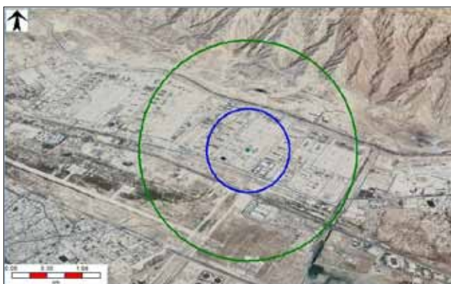
شکل ۲۰ | شعاع تحت تأثیر آتش ناگهانی در فصل گرم در اثر تخلیه‌ی کل موجودی مخزن
