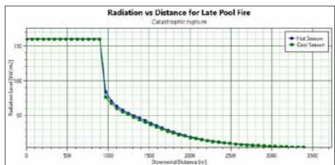
شکل ۱۶ | مقایسه‌ی شدت تشعشع بر حسب فاصله برای آتش استخری تأخیر یافته در اثر گسست مخزن
