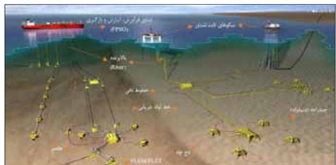
شکل ۴ | اجزاء اصلی یک میدان دریایی
