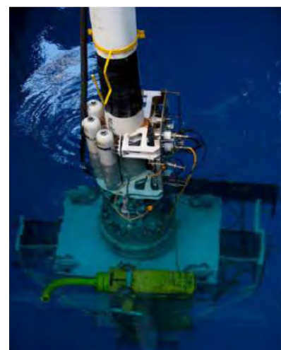
۱۱ پایین بردن Three-Ram Capping Stack در چاه Macondo برای نصب روی مجموعه فوران گیر
