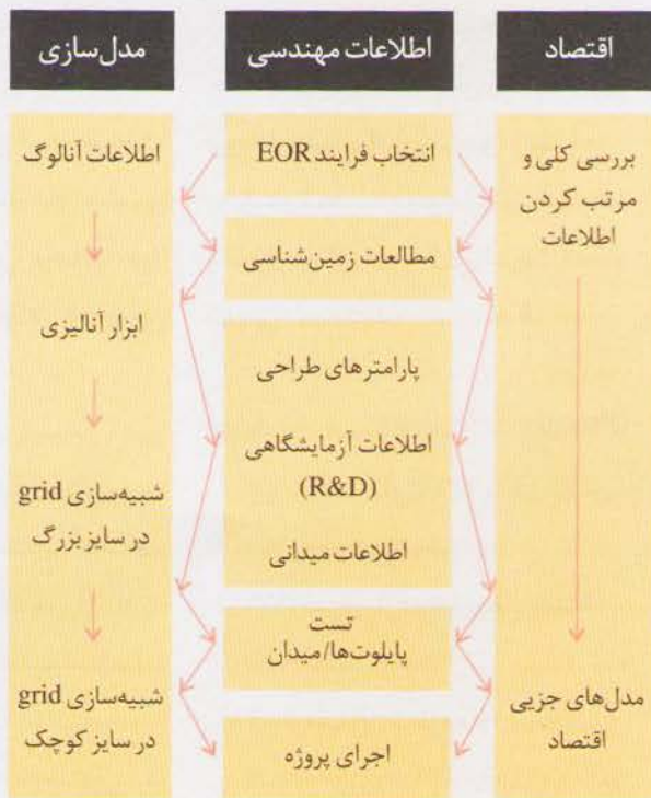
شکل ۱- مطالعات اقتصادی، شناسایی خواص مخزن و طراحی مهندسی و مدل کردن و عملکرد مخزن به صورت موازی عمل می کنند و همدیگر را در مسیر پروژه حمایت می کنند.
