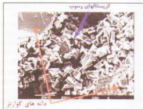
شکل ۱- تشکیل رسوب در منافذ سازند [3]
