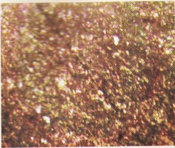
شکل ۵: نمونه ای از رخساره مادستونی که درصد تخلخل در آن خیلی کم است ( عمق ۲۸۵۹ ) مقیاس طول عکس ۴ میلیمتر
