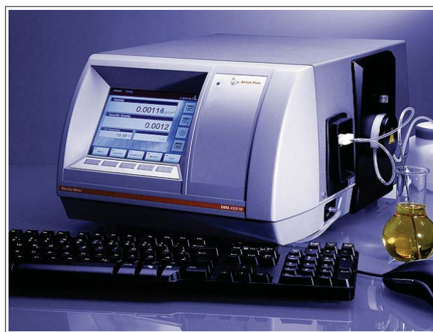
شکل ۱ | دستگاه EMV جهت اندازه‌گیری گرانیوی و چگالی نمونه نفت مرده در آزمایشگاه
