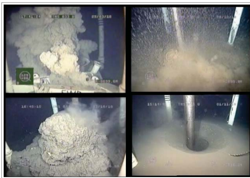
شکل ۱۴ | مراحل وقوع جریان‌های ماسه‌ای در چاه اکتشافی سردار جنگل - ۱ که توسط دستگاه ربات زیر دریایی "ROV" ثبت شده است
