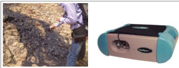
شکل ۷ | دستگاه طیف سنج FieldSpec ® 3 (راست) و عملیات طیف سنجی انجام شده (چپ)
