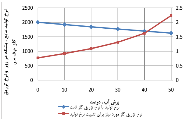
شکل ۸ | روند تغییر نرخ تولید با افزایش برش آب (آبی)، نرخ تزریق گاز مورد نیاز برای تثبیت نرخ تولید (قرمز)
