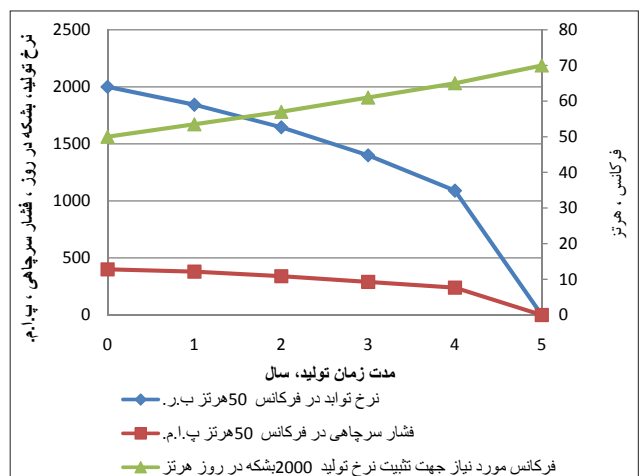
۱۱- پیش‌بینی تولید چاه در آینده با سناریو پمپ درون‌چاهی و فرکانس لازم جهت تثبیت نرخ تولید
