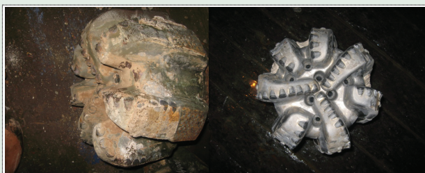
نمایی از ۲ مته از نوع PDC (سمت چپ) فرسوده و (سمت راست) نو آماده راندن به چاه
