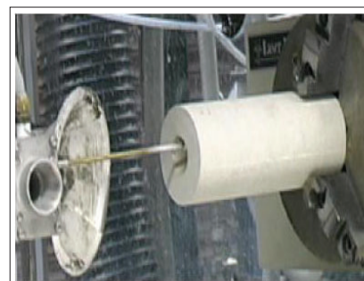
شکل ۷ | روش حرکت چرخشی سنگ که در آن از توان ۲۵۰۰ وات و سرعت چرخشی ۱۰,۰۰۰ درجه در دقیقه استفاده شده و سوراخی در نمونه ماسه سنگی با ضخامت ۷ اینچ حفر شده است.
