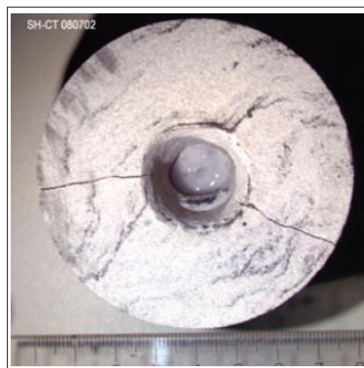
شکل ۵ | سوراخی که در ۴ مرحله ترکیدگی سنگ ایجاد شده است.
