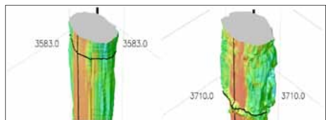
شکل ۱۰ | نمای سه بعدی از washout در عمق ۳۵۸۳ متری و ۳۷۱۰ متری چاه
