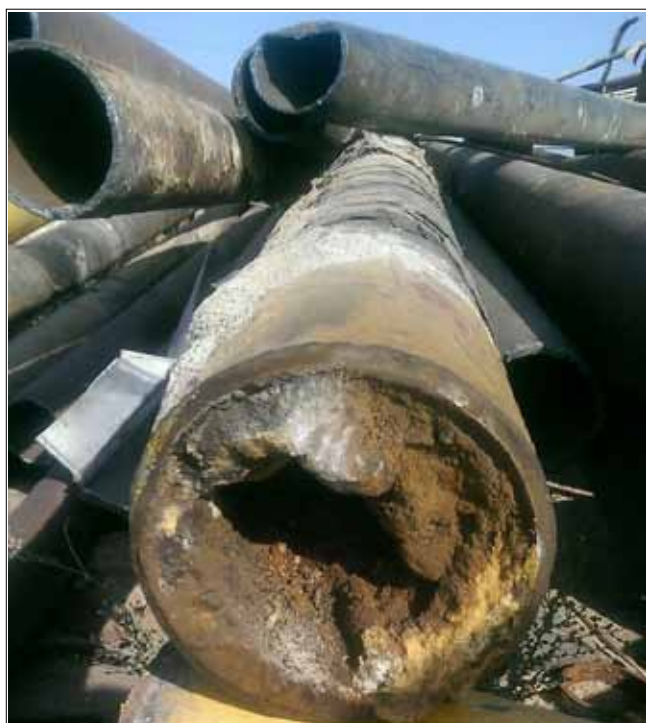
شکل ۵ | تصویری از رسوبات ایجاد شده در درون لوله منتهی به گودال سوخت چاه ۴
