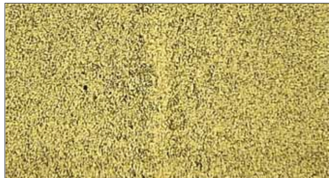
شکل ۳ | خط جوش در مرکز تصویر، ریزساختار فلز جوش مقادیر کمتر پرلیت دارد
