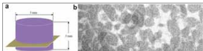
شکل ۳ | (a) نمونه ماسه‌سنگ Beres مورد استفاده در روش (b) Micro-CT تصویر از سطح مقطع سنگ در فاصله ۰/۳۷۸ میلی‌متری از سطح، رنگ سیاه نشانگر دانه‌های سنگ و رنگ سفید فضاهای خالی را نمایش می‌دهد [۹].
