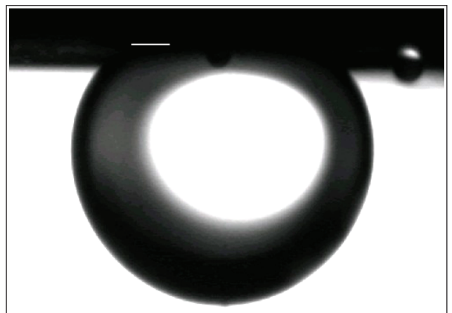
شکل ۲ | تصویر قطره آب در حضور گاز دی اکسید کربن
