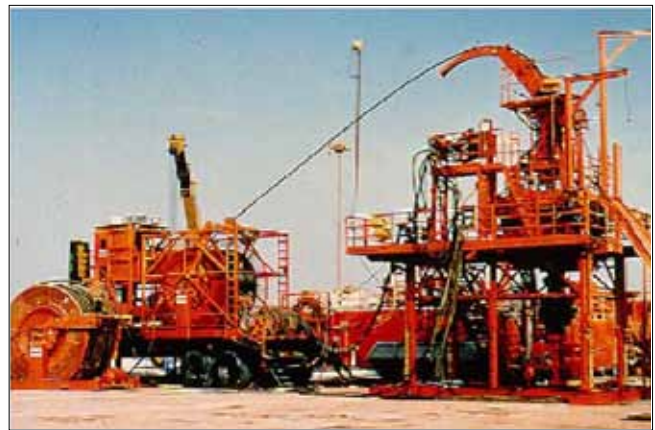
شکل ۹ | دستگاه هیبریدی لوله مغزی سیار با توانایی حفاری (CTD) در عمان (شرکت DOWEL)
