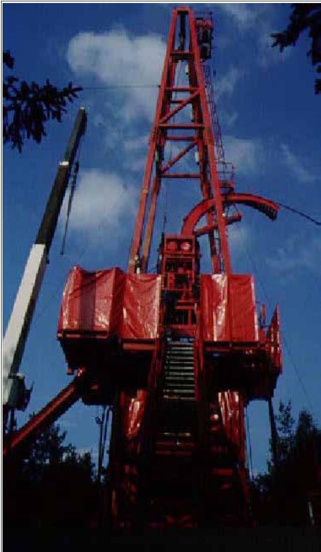
شکل ۱۰ | دستگاه لوله مغزی سیار CTD هیبریدی همراه با دکل ثابت
