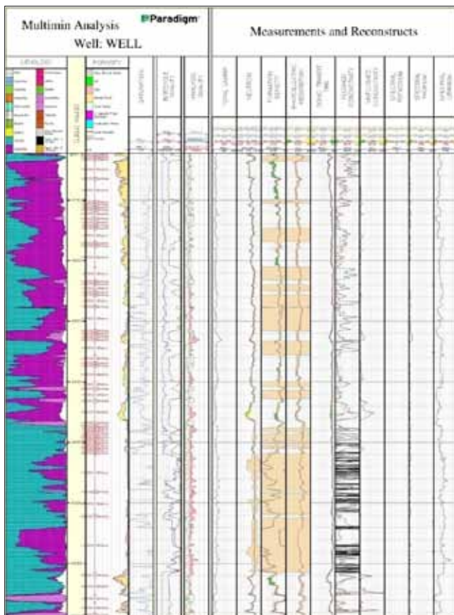
۱ | نمودارهای حاصل از روش multimin برای بخش k3. در این تصویر لایه‌هایی از کلسیت، دولومیت و انیدریت و نیز نمودارهای حاصل از مدل‌سازی جهت تخمین نوع و حجم سیال محیط ارائه شده است
