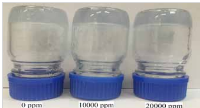
شکل 1 | بررسی استحکام هیدروژل‌ها در تست بطری
