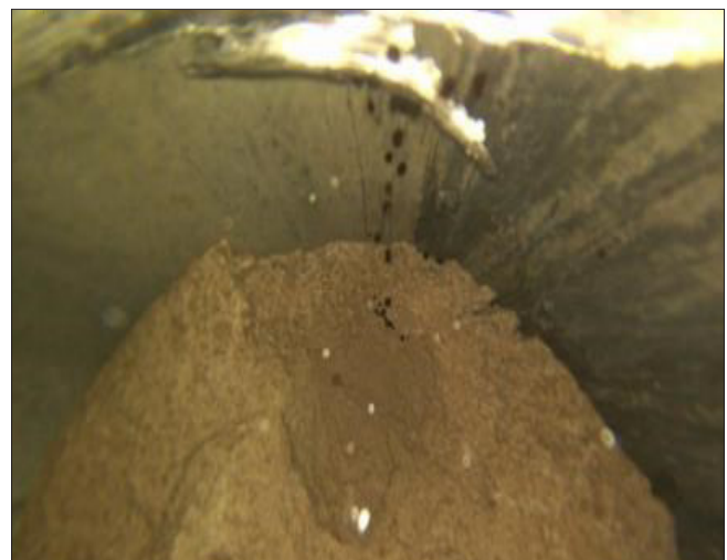
شکل ۸ | نشست سیال نفت از سیمان ته‌چاهی
