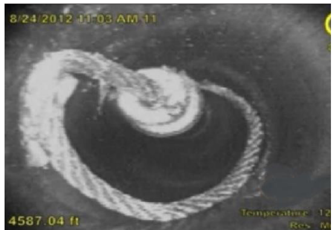
شکل ۳ | سرپیچ رشته‌ابزار به همراه مقدار کمی کابل چاه‌پیمایی مانده در چاه
