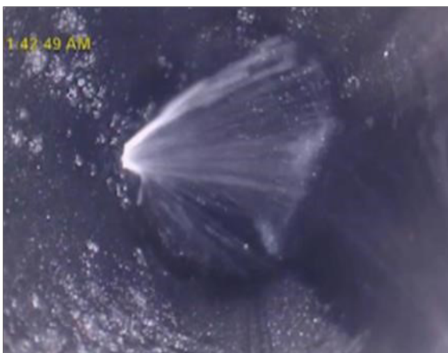
شکل ۱۰ | عبور سیال از مشبک‌ها
