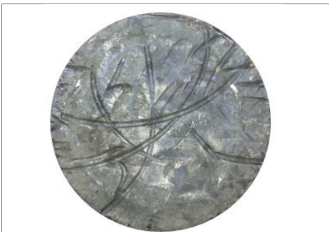
شکل ۲ | اثر سیم چاه‌پیمایی کلاف شده
