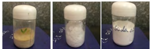
شکل ۱ | مواد مورد استفاده جهت تهیهی نانو گل حفاری (از راست به چپ به ترتیب سودا اش، کاستیک و زانتان گام)
