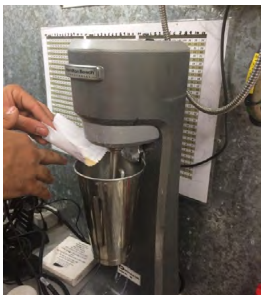
شکل ۳ | همزن جهت تهیهی نانو سیال
