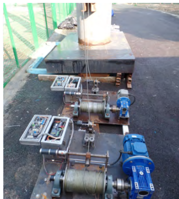
شکل ۲ | موتورهای AC مربوط به سیستم آشکارسازی که باعث چرخش استوانه حامل سیم بسکل شده و آن را جمع یا باز می‌کنند (موتورهای قرار گرفته در سمت راست سینی‌ها). موتورهای DC که ردیف‌سازی سیم بکس‌ها را بر روی استوانه حامل سیم بکسل بر عهده دارند (موتورهای قلمی شکل قرار گرفته در سمت چپ سینی‌ها).
