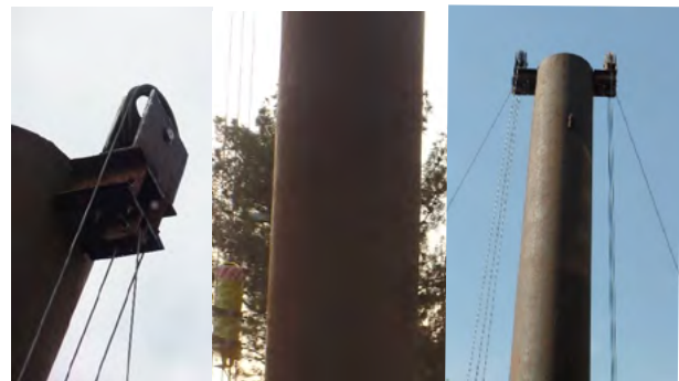
شکل ۸ | تغییر حالت سیستم آشکارساز-چشمه از حالت یک سیم بکسلی (شکل‌های بالایی) به سه سیم بکسلی (شکل‌های پایینی)
