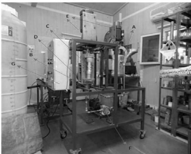
نماهایی از لوپ TPFHL. (A) مخزن آماده‌سازی سوسپانسیون / امولسیون، (B) مخزن همگن‌سازی، (C) آشکارساز سوسوزن، (D) حفاظ سربی چشمه رادیواکتیو گاما، (E) الکتروموتورها، (F) الکترومپ، (G) برد الکترونیکی کنترل دستگاه. با تضمین حضور یک مخلوط دوفازی همگن امکان اندازه‌گیری کسر حجمی فازها با استفاده از تکنیک گامای عبوری فراهم می‌شود.
