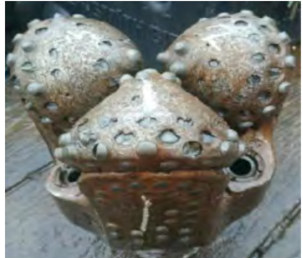
شکل ۱ | مته‌ی کاجی استفاده شده در سنگ‌های کربناته‌ی سخت حاوی چرت [۸]
