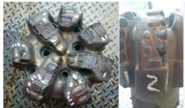
شکل ۲ | مته‌ی PDC استفاده شده در سازند کربناته‌ی سخت حاوی چرت [۷]
