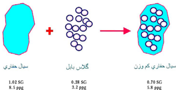
شکل ۲ | راهکار حباب شیشه‌ای جهت کاهش وزن گل حفاری [۵]
