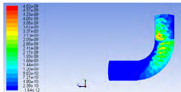
شکل ۱۷ | نمای جانبی از کانتور سایش در فشار طراحی (۲۵۰ psi) (برای جریان دارای ذرات ۱۰ میکرون)
