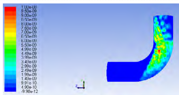
شکل ۹ | نمای جانبی از کانتور سایش در فشار ۲۰۰۰ psi (برای جریان دارای ذرات ۵ میکرون)
