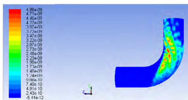
شکل ۷ | نمای جانبی از کانتور سایش در فشار طراحی ۲۵۰ psi (برای جریان دارای ذرات ۵ میکرون)
