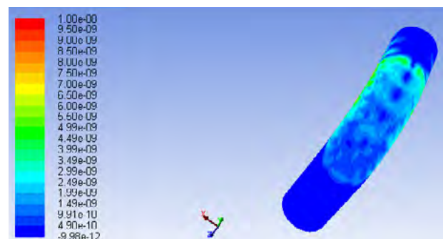
شکل ۱۰ | کانتور سایش در فشار ۲۰۰۰ psi (برای جریان دارای ذرات ۵ میکرون)
