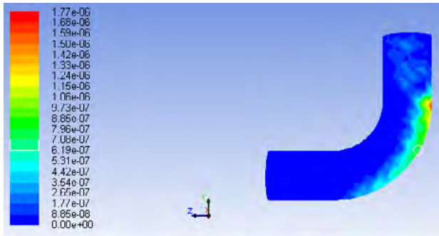
شکل ۲۱ | کانتور سایش در فشار طراحی ۵۰ psi (برای جریان دارای ذرات ۱۰ میکرون)
