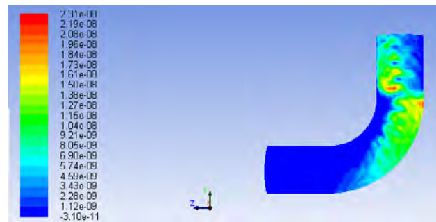
شکل ۱۹ | نمای جانبی از کانتور سایش در فشار ۱۵۰ psi (برای جریان دارای ذرات ۱۰ میکرون)
