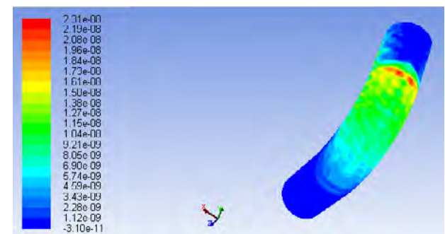
شکل ۲۰ | کانتور سایش در فشار ۱۵۰ psi (برای جریان دارای ذرات ۱۰ میکرون)
