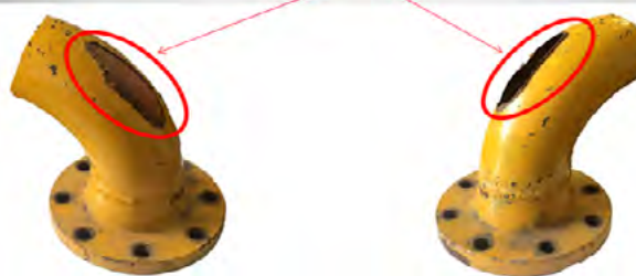
۲۳ | نمونه واقعه‌ای از ساییش در زانو یکی از ایستگاه‌های تقلیل فشار در صنعت گاز
