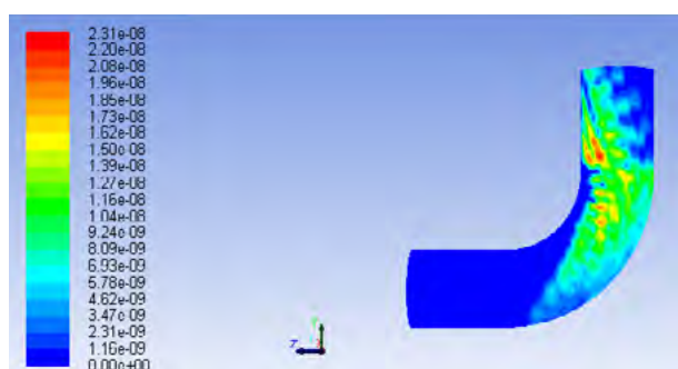
شکل ۱۱ | نمای جانبی از کانتور سایش در فشار ۱۵۰ psi (برای جریان دارای ذرات ۵ میکرون)
