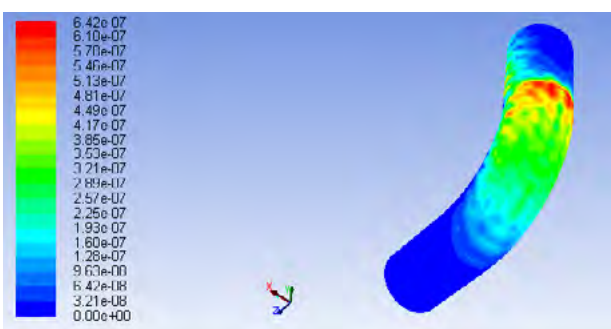
شکل ۱۶ | کانتور سایش در فشار ۵۰ psi (برای جریان دارای ذرات ۵ میکرون)
