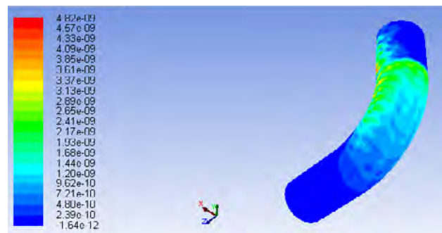
شکل ۱۸ | کانتور سایش در فشار طراحی ۲۵۰ psi (برای جریان دارای ذرات ۱۰ میکرون)
