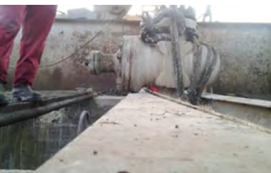
شکل ۱۶ | خمش بیم زیر Top Master Valve
