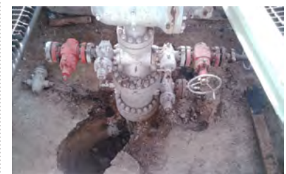
شکل ۷ | کندن قسمتی از سلر به منظور بررسی وضعیت فلنج مینا
