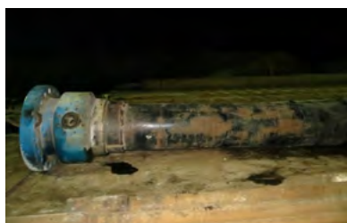
شکل ۲۹ | جوشکاری ماسوره سر لوله جداری "3K-13-5/8 بر روی جداری "13-3/8
