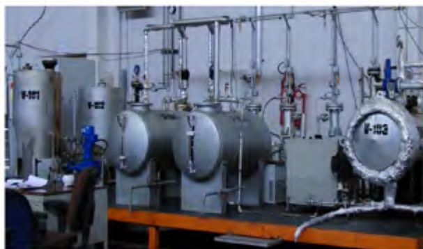
شکل ۱۱ | پیلوت نمک‌زدای نفت‌خام در پژوهشگاه صنعت نفت
