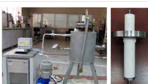
شکل ۱۰ | (الف) بوشینگ ورودی ولتاژ بالا ساخت پژوهشگاه صنعت نفت؛ (ب) سیستم آزمون عملکرد قطعه [۲۳]
