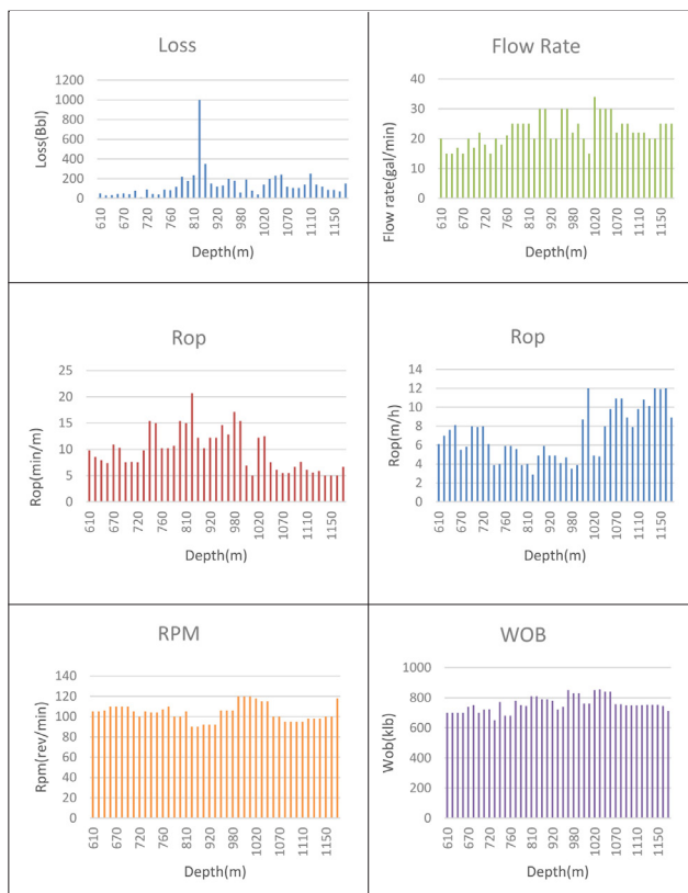
شکل ۲ | بررسی متغیرهای مختلف مؤثر حفاری بر حسب عمق در چاه-B
