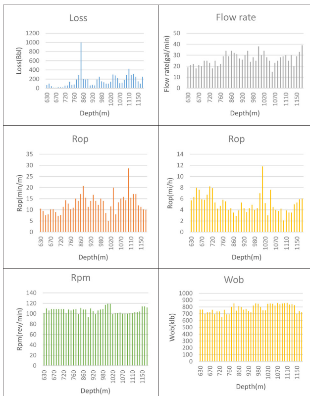
شکل ۱ | بررسی متغیرهای مختلف مؤثر حفاری بر حسب عمق در چاه A
