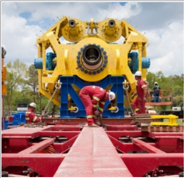
شکل ۹ | موفقیت شرکت شل برای انتقال یک سیستم درپوش به طول ۷ متر، تا عمق ۲۰۰۰ متری
