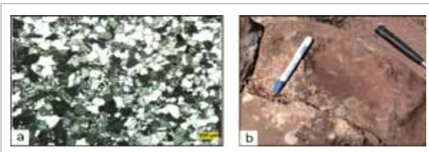
شکل ۵ | (a) دانه‌های کوارتز، ارتوکلز و خرده‌سنگ چرت در رخساره لیتارنایت ماسه‌سنگ توده‌ای سازند شوربچه؛ (b) ماسه سنگ توده‌ای قرمز با آشفستگی زیستی.
