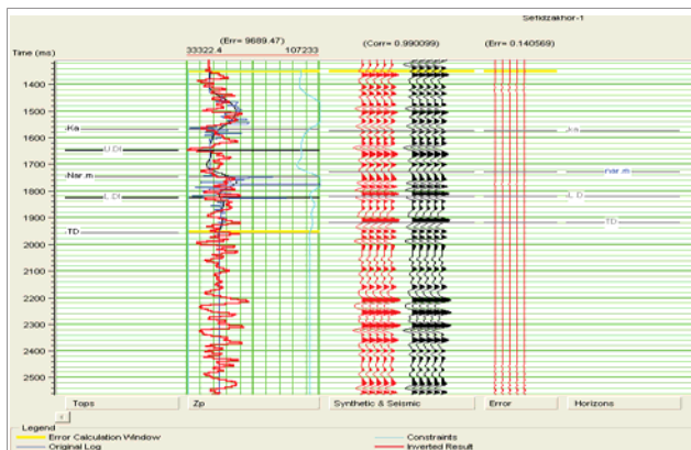
شکل ۷ | همبستگی میان رد مصنوعی و لرزه واقعی در محل چاه با خطای ۱۴ درصدی و RMSE = 9689.47
