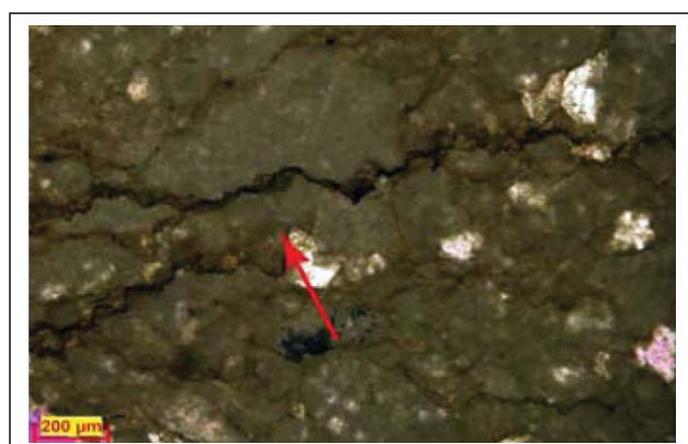
شکل ۴ | نمونه ای از تخلخل استیلولیتی مشاهده شده در عمق ۴۲۱۸ متر حفار در چاه ماهشهر ۱
