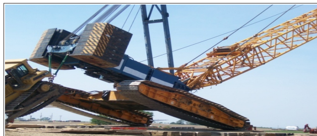
شکل ۳ | حادثه برای جرثقیل به علت برداشتن بار بیش از حد مجاز
