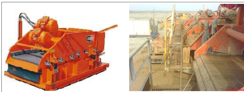
شکل ۱ | جداسازی ذرات درشت در دستگاه الک لوزان
