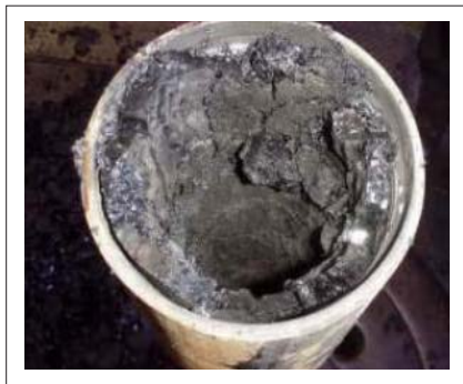
شکل ۱ | ته‌نشست آسفالتین در لوله انتقال نفت
